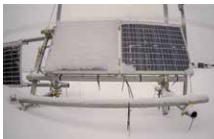
図3：太陽光パネル表面への着雪例（左：通常のアクリル表面 右：超撥水表面）
