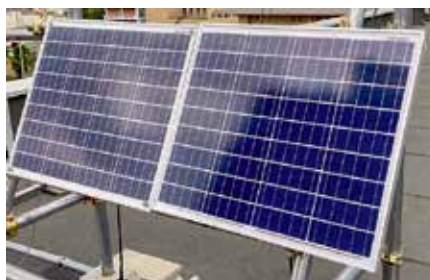
図2：太陽光パネル（左：通常のアクリル表面 右：超撥水表面）
